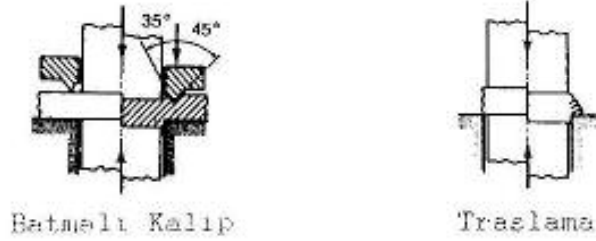
Şekil 8-12: Batmalı kalıp ve traşlama yöntemleriyle hassas kesme.
